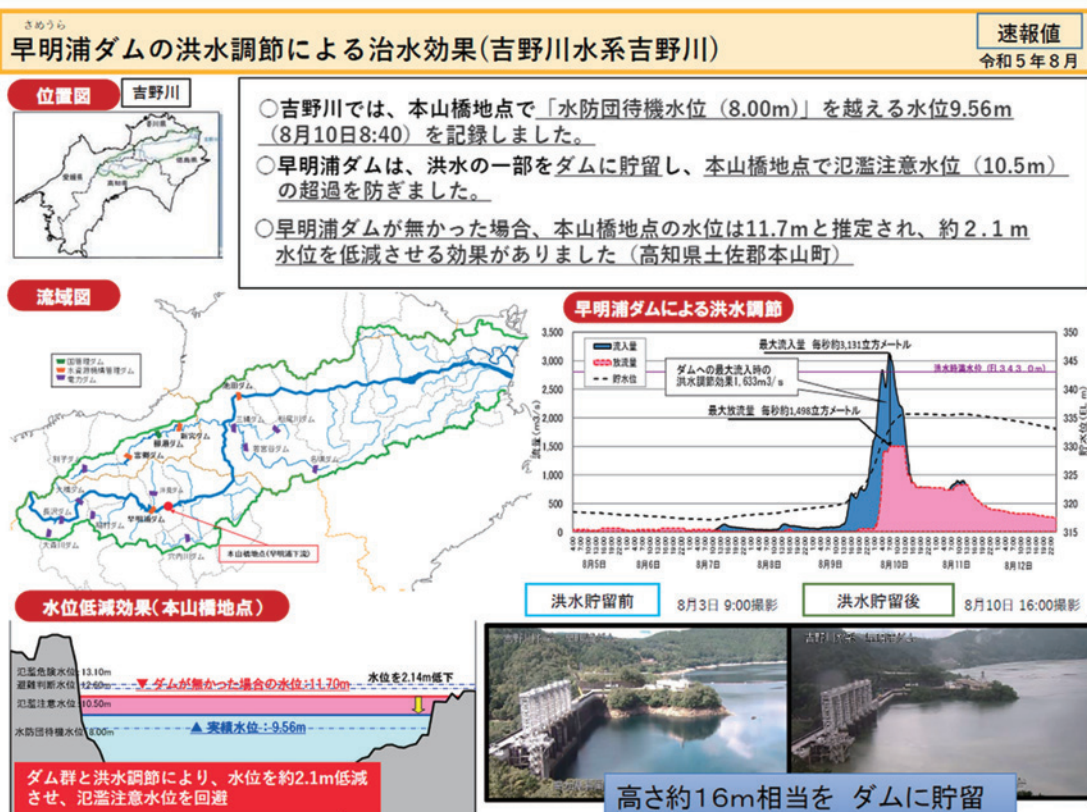
図－2 早明浦ダムによる洪水調節効果
